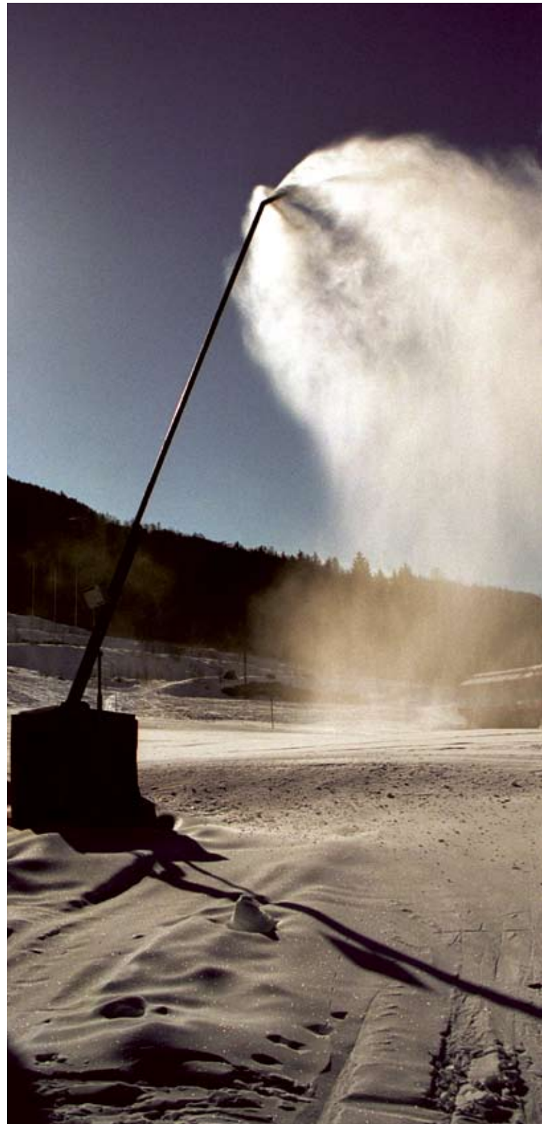
Støysvak automatisk lanse plassert utenfor fallsone
