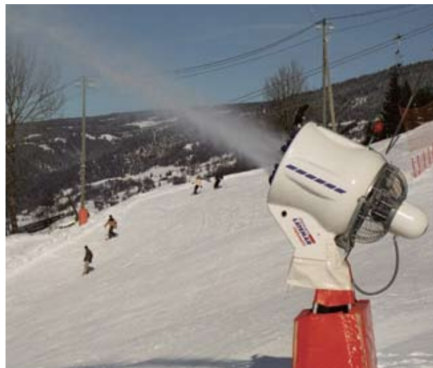
Automatisk viftekanon plassert i overkant/siden av løypa
