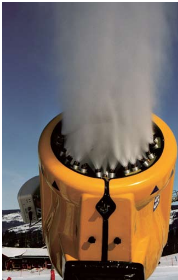
Viftekanon med få og store vanndyser
