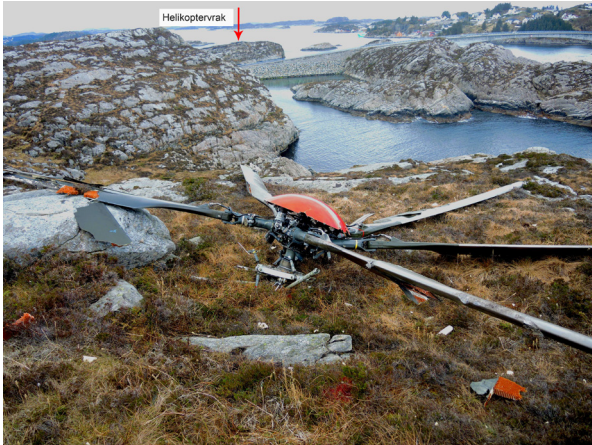
Rotormast og rotorhode fra LN-OJF. Bilde er tatt i retning av havaristedet. Foto: SHT
