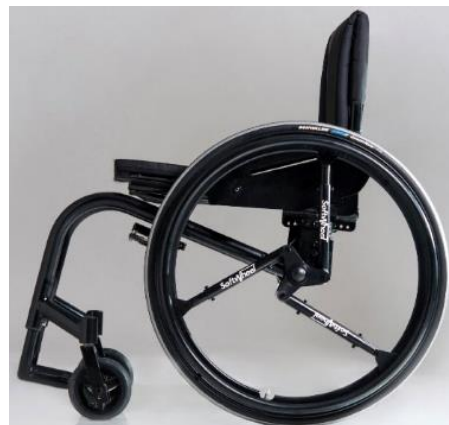
Aktivstol med demping i svinghjul og tre dempende «eiker» i drivhjulet
