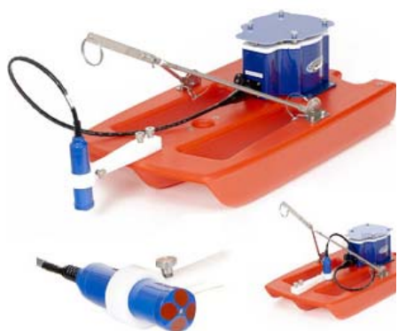
Figur 2.1 StreamPro ADCP montert og klar for måling.
