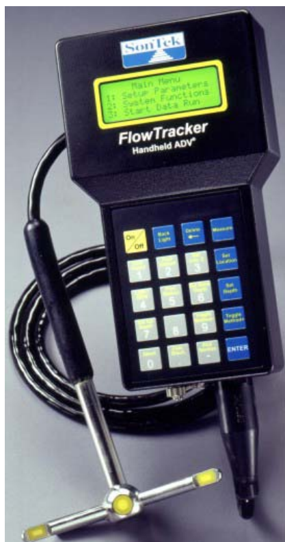
Figur 2.2 Vannføringsmåling med Flow Tracker
