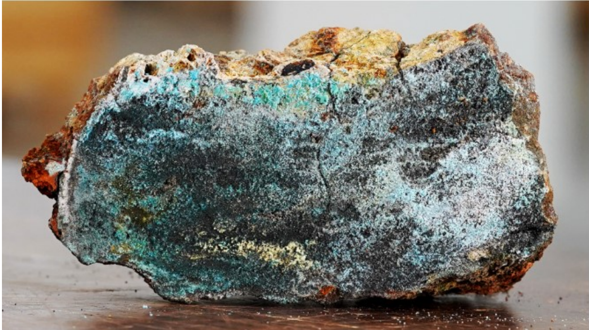
Figur 4-3. En gjennomskåret sulfidprøve, hentet opp fra Oljedirektoratets tokt på Mohnsryggen i Norskehavet i 2020. Det grønnlige mineralet er atakamitt, som er rikt på kobber. Foto: Øystein Leiknes Nag, Oljedirektoratet.
