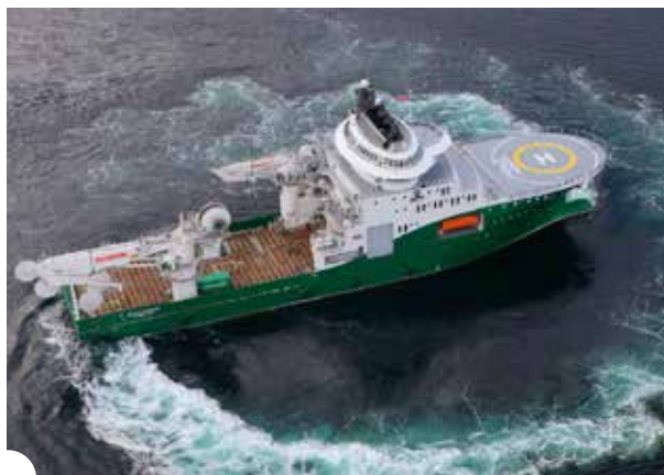
Kranene på dette offshorefartøyet er levert av Cargotec i Kristiansand, medlem i NCE NODE. Kranene kan halde gjenstandar i ro på store havdjup, sjølv om båten blir utsatt for høge bølger. Foto: NCE NODE
