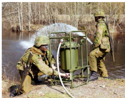
Figur 11 Vannrenseanlegg (Foto: FMS)
