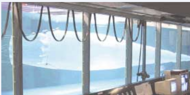
Testing av raudåtrål i forsøkstank, forsøkslaboratoriet, Hirsthals
