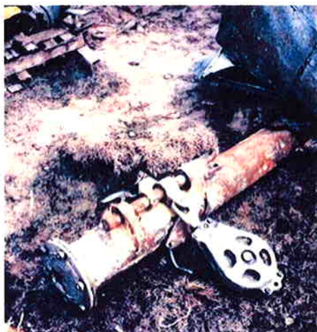
Figur 8. Nedre del av avbrekt mast med mantelwireblokk.
