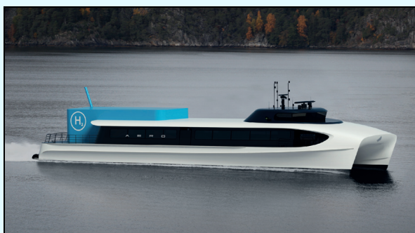
Figur 4.16 Slik kan fremtidens nullutslippshurtigbåt se ut. Dette er «Aero Hydrogen 40», et konsept utviklet av Brødrene Aa i samarbeid med Westcon Power og Automation, Boreal sjø og Ocean Hyway Cluster. Båten skal kunne drives på batteri og hydrogen, gå i 34 knop med en motoreffekt på 2600 kW og kunne ta 277 passasjerer.
