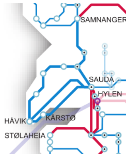
Figur 22: SKL-ringene rundt 2020 med oppgraderingskonseptet. Tykke streker markerer duplex/triplex. Røde streker markerer 420 kV drift.
