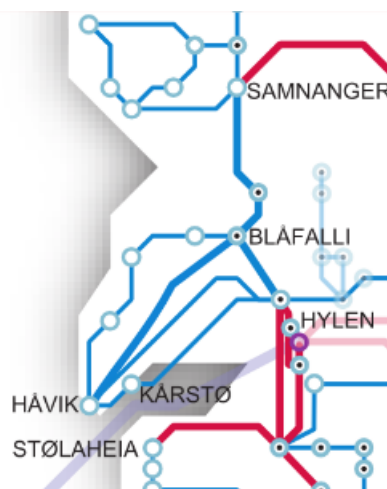
Figur 23: SKL-ringen med ny ledning fra øst. Tykke streker markerer duplex/ triplex. Røde streker markerer 420 kV drift.
