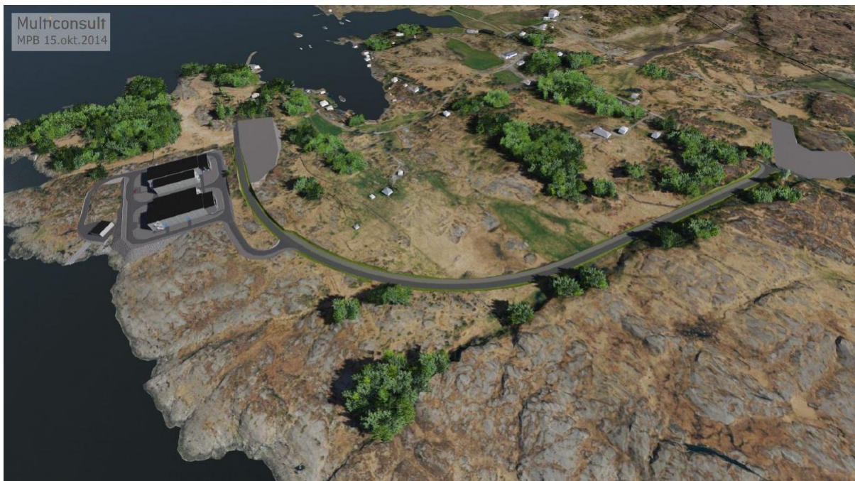
Figur 6: Omformerstasjon med adkomstveg og planlagte områder for lagring av masser/riggplasser (Kilde: Konsekvensutredning november 2014)
