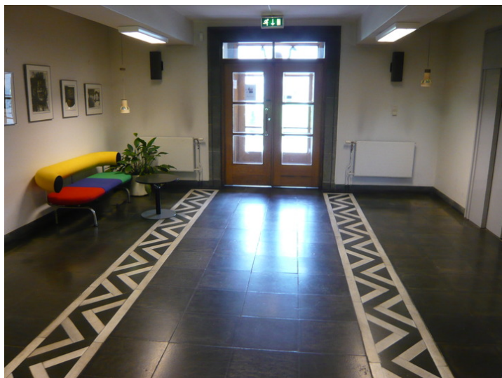
Vestibylen er enkelt utformet, der det rikt utformede gulvet i sort skifer med mønster i hvit marmor er rommets utsmykning. Opphavsrett: Statsbygg.
