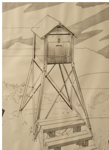
Værhytte, eldre type - for innsamling av værdata.
