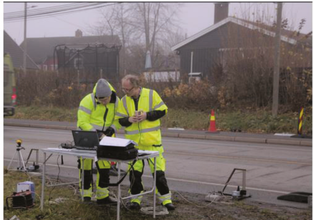
Overingeniør Nils Johannes Mikkelsen og senioringeniør Kristian Ellingsberg fra Justervesenet tester de nye fartsmålerne «live».
