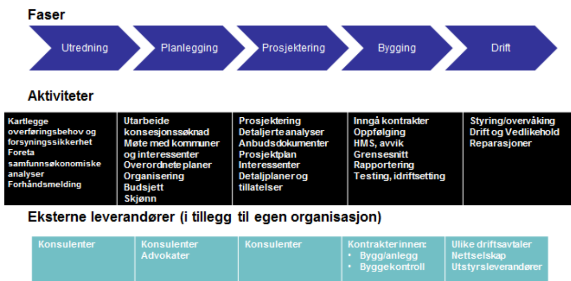
Figur 42 Verdikjede for transmisjon, kilde: Statnett
