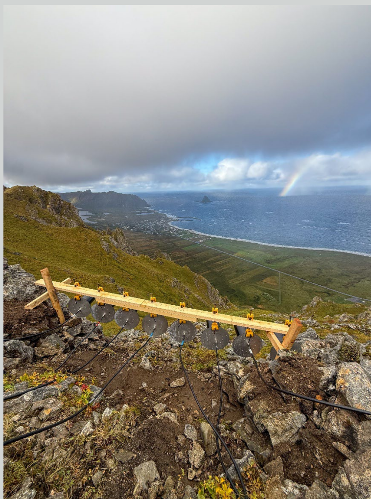
Figur 4.2 Jammeutstyr (antennerigg) brukt på Jammertest 2025 på Andøya. Foto: FFI
