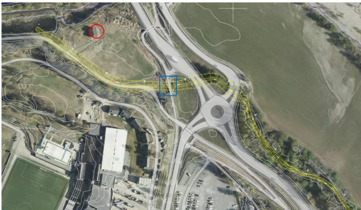
Figur 9. Mulig løsning for åpning av Vesle-Gausa. Flomløpet foreslås her lagt i veien til pumpehuset (rød ring) som tidligere var flomløpets opprinnelige løp frem til den gamle brua over Vesle-Gausa som i dag er gang- og sykkelvei (blå firkant). Videre i to kulverter under rundkjøringen på Jorekstad og frem til opprinnelig løp nedover langs Bronsøya.
