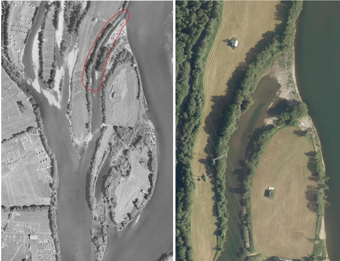
Figur 12. Tv. Midtre flomløp før flomforbygningen ble etablert. T.h. Midtre flomløp med flomforbygning på ca. 1 m høyde. Kilde: Finn kart.
