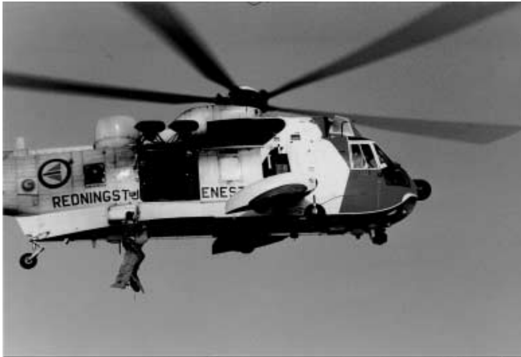
Figur 2.3 GKN Westland Sea King i modernisert utgave med ny søkeradar, to redningsheiser, neserader og varmesøkende kamera. Foto: Bjørn Haugerud
