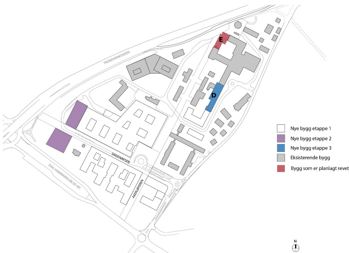
Figur 10. Etappe 3 (Prosjekteringsgruppen, 2019). Merk at bygg E ikke er sikret revet i reguleringsplanen som følge av forutsetninger nevnt i avsnittet over.
