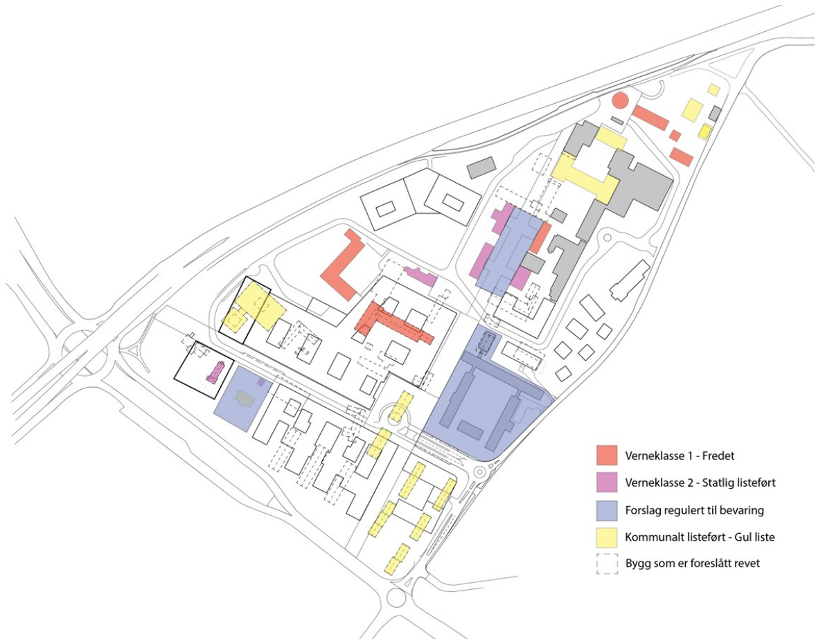
Figur 26 Planalternativ 1A. Illustrasjonen viser hvilke bygninger som rives (stiplet) og hvilke som bevares. Prosjekteringsgruppen, 2019
