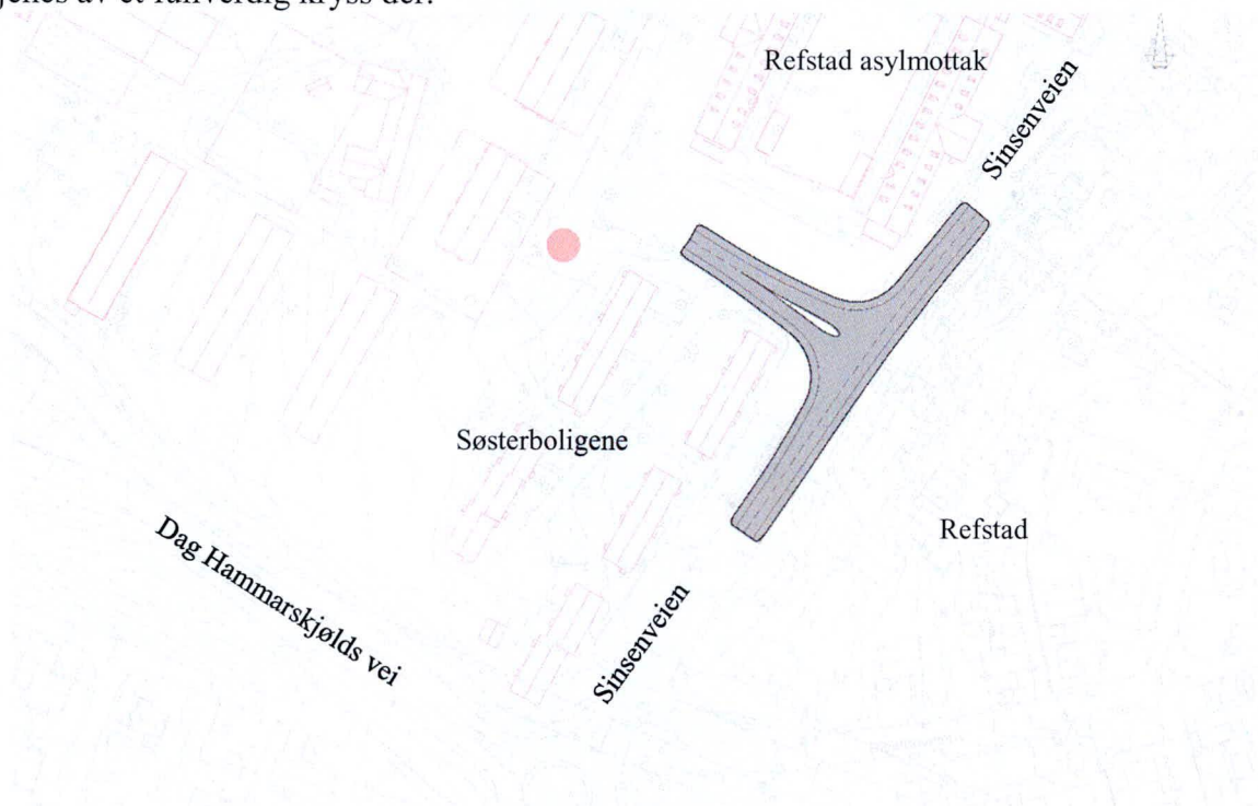
Figur 14 Prinsipp tegning forslag til atkomst fra Dag Hammarskjølds vei/Sinsenveien
