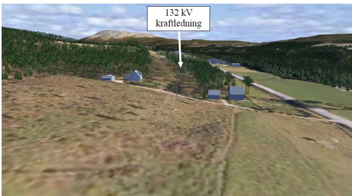
Figur 11: Nettalternativ 1.2. Eksisterende 22 kV-nett kables (inkludert avgreininger nord og sør for Storbekken), mens ny 132 kV-kraftledning bygges som luftledning i den gamle traseen.
