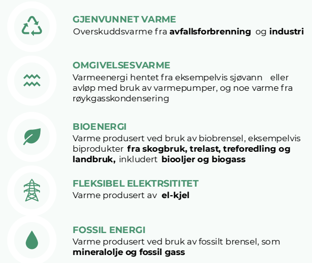
Figur 2-2: Varmekilder for produksjon av fjernvarme
