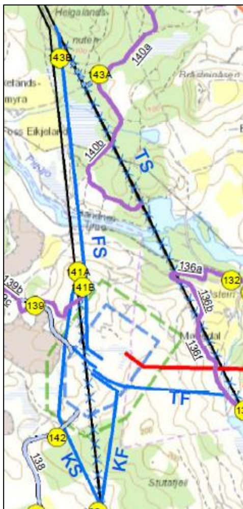
Figur 29 Fagraftjell stasjon og omlegginger 300 kV-ledninger. Nye 300 kV-traseer er vist med blå streker, og 300 kV-traseer som fjernes med svarte streker og blå kryss. (Kilde: Statnetts oktober 2017)
