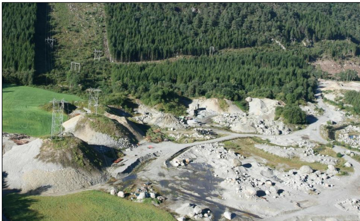
Figur 31 Dagens 132 kV-ledninger over masseuttaket på Fossanmoen. Den ene sandhaugen vil bli fri for master når ledningen Lyse–Tronholen 2 rives. (Kilde: Konsesjonssøknad av mai 2013)
