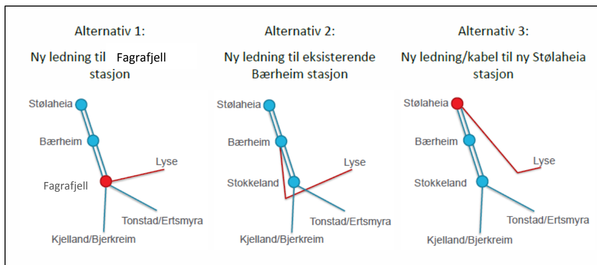
Figur 10 Tre alternative konsepter for ny 420 kV-forbindelse til Sør-Rogaland. Røde linjer er 420 kV, og blå linjer er 300 kV. (Kilde: Statnett)
