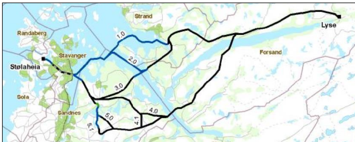
Figur 7 Traseer som ble foreslått utredet i 2012. Svarte streker er luftledning, blå streker er sjøkabel og stiplet strek er kabel i tunnel. (Kilde: Ny sentralnettforbindelse til Sør-Rogaland - En oversikt over behov, aktuelle løsninger og tema som planlegges konsekvensutredet, Lyse Sentralnett 2012)
