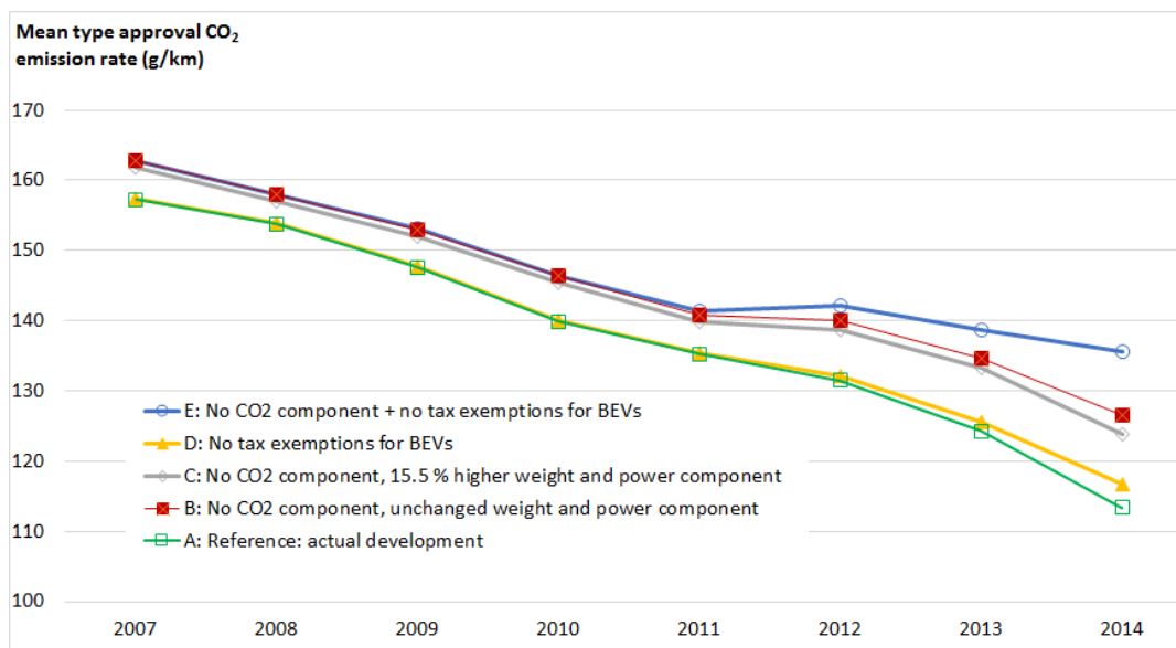
Fig. 3. Kontrafaktisk simulering av ulike alternativ for engangsavgift på personbiler 2007-2014. Kilde: Østli et al. (2015).
