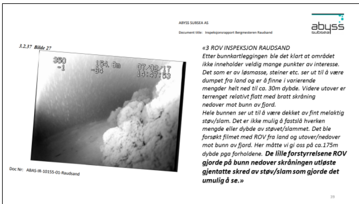
Figur 16 Små forstyrrelser fra en ROV utløste skred av støv/slam nedover i fjordsiden. Kilde: Abyss Subsea – Inspeksjonsrapport sjøbunnkartlegging Bergmesteren Raudsand (vår utheving)
