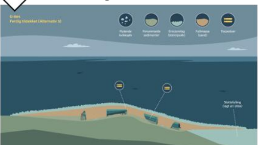
Figur 34 Alternativ 3 Heving av last og tildekking av vrak og forurenset havbunn - Prinsippskisse av tiltakets ulike steg basert på metode 4 Kutte. Steg 4 Overvåkning av tiltaksområdet og Deponering er ikke vist her. Disse vil være tilsvarende som for i foregående kapittel for metode 1b Grave
