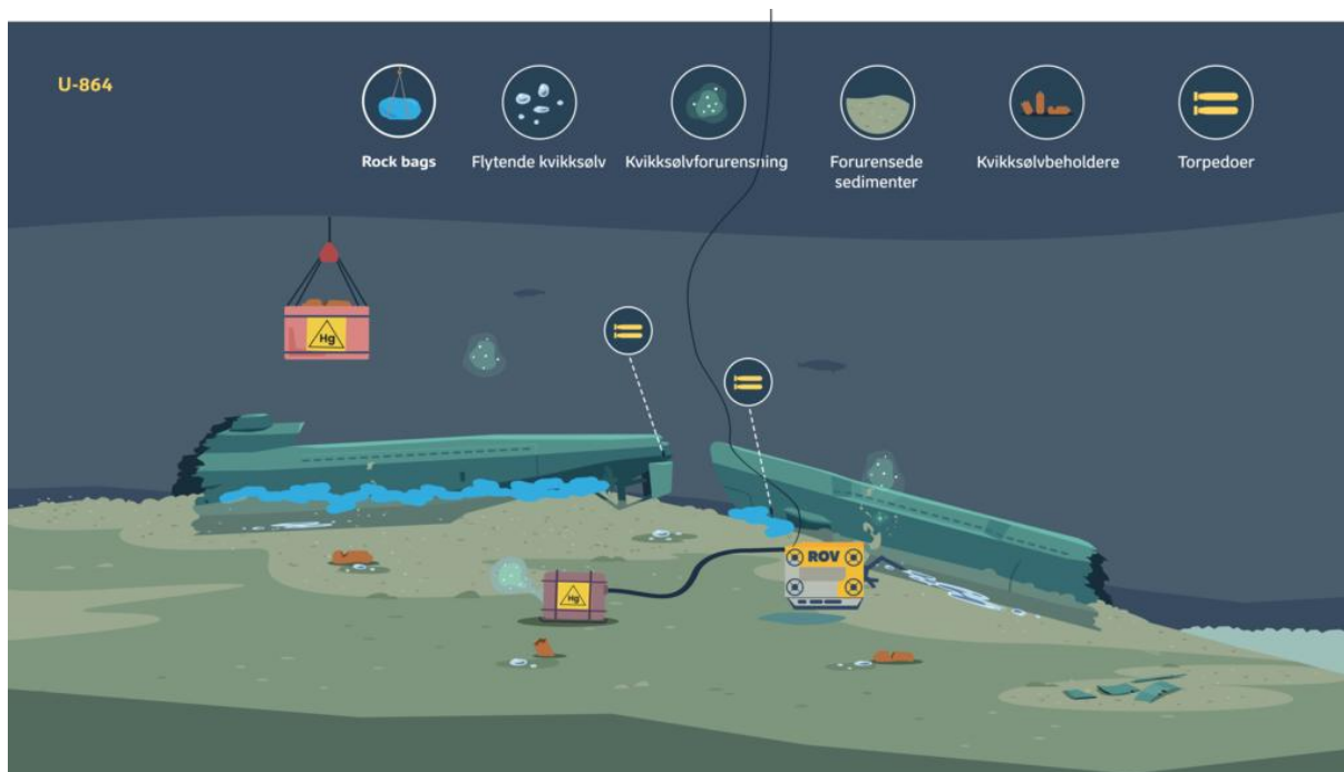
Figur 29 Illustrasjoner av Steg 1. Øverste bilde viser sugemudring av en del langs forseksjonen, mens en del lengst fremme er ferdig stabilisert etter uttak av kvikksølvlast. I samme bilde vises uttak av kvikksølvbeholdere ved akterseksjonen og mellomlagring av disse på sjøbunnen. Nederste bilde viser oppsugning av flytende kvikksølv som pumpes over i en container, mens akterseksjonen er ferdig stabilisert etter arbeider med å heve lasten.
