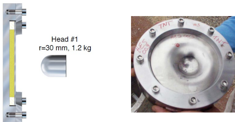
Figur 7.5: Steven Impact test [32–33] En «puck» av sprengstoff er plassert bak en 3,18 mm tykk frontplate, med en bakplate på 19 mm, innesluttet langs radien av en teflonring og 26,7 mm stål.
