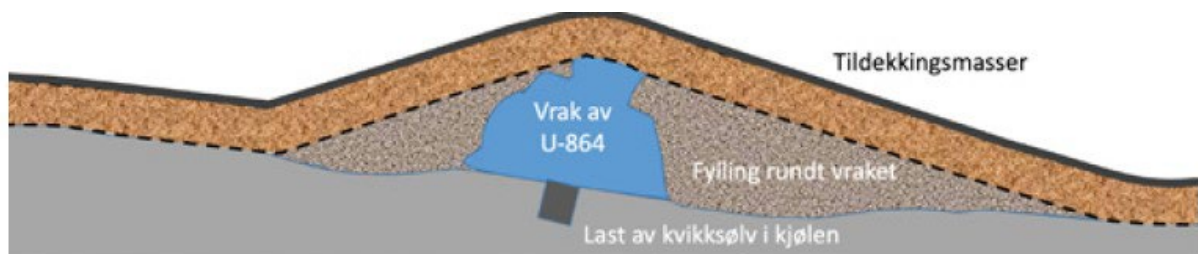
Figur 6.4 Illustrasjon som viser et tverrsnitt av oppbyggingen av tildekkingen rundt vrakseksjonen Kilde: (Kystverket 2014, 21)
