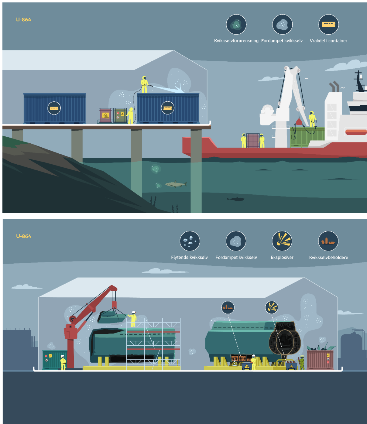
Figur 4 Illustrasjoner av Steg 2. Øverste bilde viser løfting av en container med vrakdel om bord på fartøyet. Containeren løftes om bord på en «skitten sone» for rengjøring utvendig. Det vil være risiko for eksponering av kvikksølvforurensning til sjø, luft og til personell i denne delen av operasjonen. Midterste bilde viser mottak ved landanlegg av kvikksølvlast i form av containere med vrakdel og beholdere med frittflytende kvikksølv. Nederste bilde viser til høyre en vrakseksjon der det fjernes eksplosiver/ammunisjon og kvikksølvbeholdere som tas ut av kjølkassen. Vrakseksjon til venstre dekommisjoneres etter at alt innhold er fjernet og håndtert.
