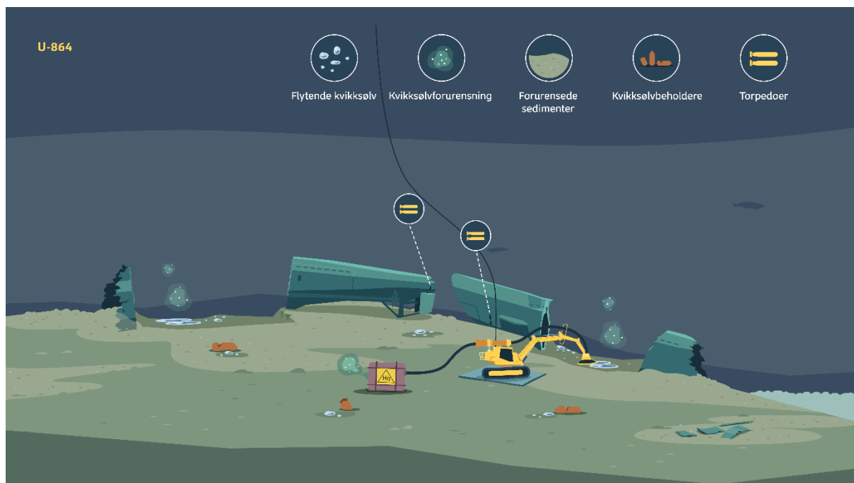
Figur 3 Illustrasjoner av Steg 1. Øverste bilde viser graving av sedimenter for plassering av kuttemaskin ved fremre del av forseksjon, en kuttemaskin som kutter ved bakre del av forseksjon, og løfting av ferdig kuttet seksjon fra ubåtens akterseksjon ut av sedimentene og over i en container på sjøbunnen. Duk for oppsamling av fritt flytende kvikksølv som kan komme fra kjølkassene er illustrert. Nederste bilde viser en maskin som suger opp fritt flytende kvikksølv fra grop i sjøbunnen etter at seksjon er løftet opp.
