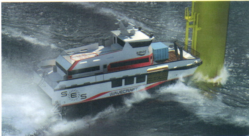
De nye katamaranene vil kunne utføre serviceoppdrag på vindmøller i opptil 2,5 meters bølgehøyde. (Illustrasjon: UMØE Mandal AS)
