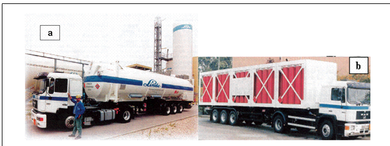
Figur 5.1 Eksempler på lastebiltransport av hydrogen i flytende (a – Linde, 3400 kg H_2 og komprimert form (b – MAN-BOC, 530 kg H_2 ved 200 bar i komposittanker)
