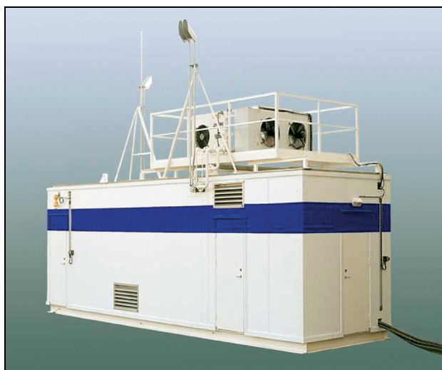
Figur 5.3 Elektrolysør i container installert i Reykjavik og Hamburg 2003. Elektrolysørene er levert av Norsk Hydro Electrolysers AS og betjener hver 3 brenselcellebusser. Kapasitet på 60 Nm 3 /h, 15 bar.
