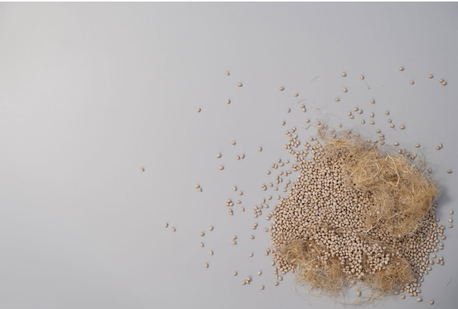
T.v.: Materialet kombinerer biopolymer og naturfibre og erstatter aluminium og fossile råstoffer.
