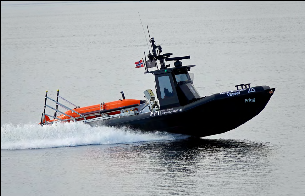
Figur 3.6 Forsvarets forskningsinstitutt (FFI) spiller en helt sentral rolle i Norges militære forskning og utvikling. FFI utvikler blant annet et autonomt minesøk og -sveip system. Bildet viser et ubemannet overflatefartøy med den autonome sonaren Hugin på dekk.
