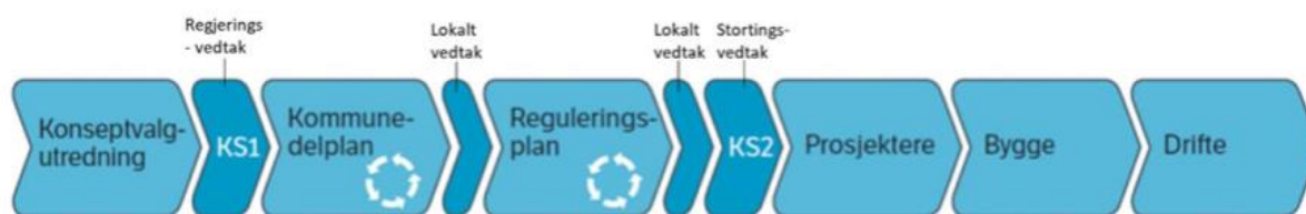
Figur 3-1: Oversikt over fasene i et større veiprojekt innen SVV. Kilde: Concept Arbeidsrapport 7-2020 46
