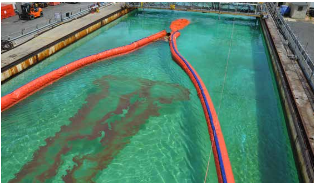
NorLense Oljetrål er et norskutviklet aktivt lensesystem, her under testing i OHMSETT, USA.
