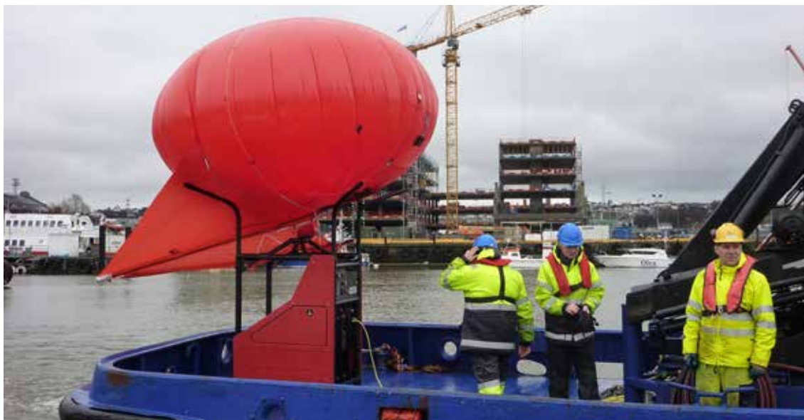
OceanEye er en norskutviklet heliumfylt aerostat for overvåking som nå selges internasjonalt.
