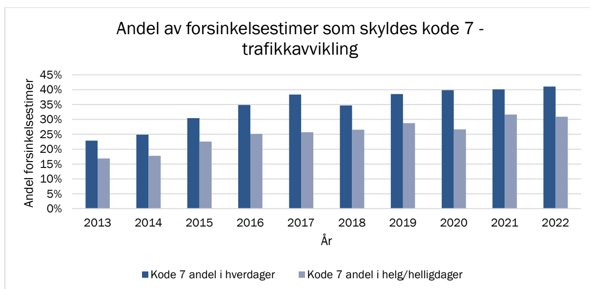
Figur 27: Figuren viser andelen forsinkelsestimer for persontog (ikke inkludert ekstratog) som er registrert med kode 7 - trafikkavvikling på hverdager og helg/helligdager. Figuren viser at andelen av kode 7 er høyere på hverdager enn ved helg/helligdager.
