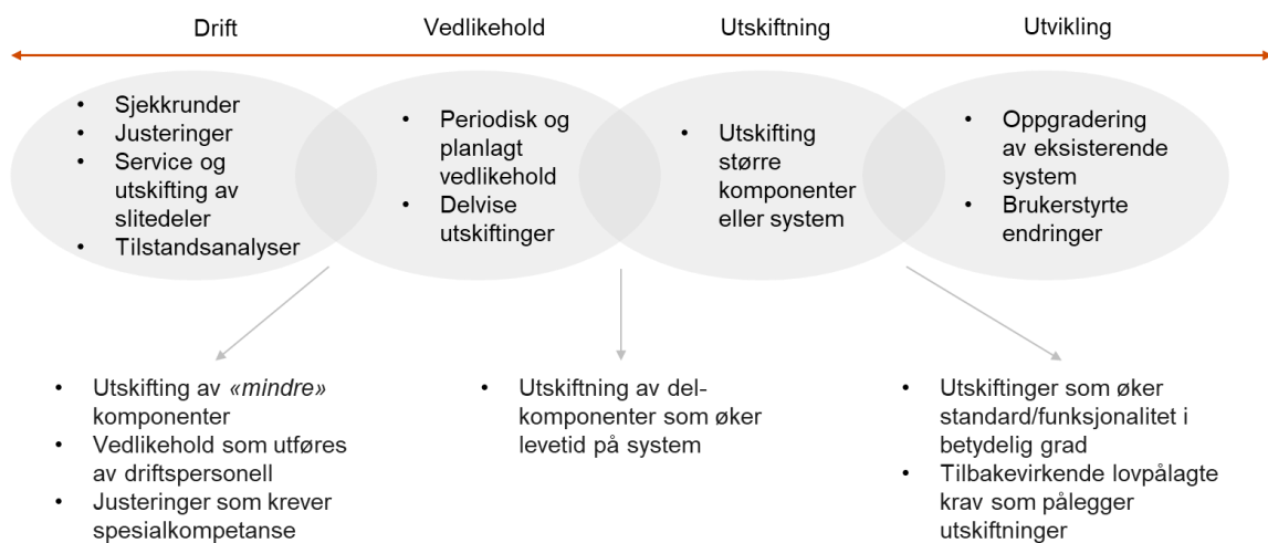
Figur 3.2 Illustrasjon av grensesnitt og overlapp mellom begrepene drift, vedlikehold, utskifting og utvikling i praksis
