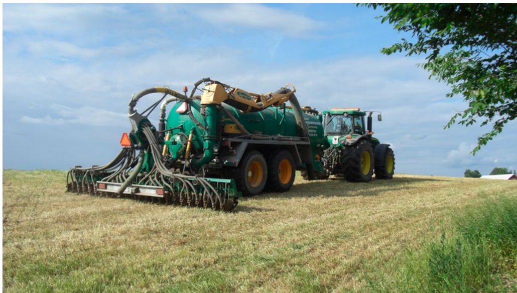
Gjødselnedfelling gjennom stripespreiing er eit eksempel på meir effektiv og presis utnytting av innsatsfaktorar i jordbruket. Metoden reduserer lukt og gir mindre unødige utslepp av næringsstoff og ammoniakk til vatn og luft. Foto: Svein Skøien, NIBIO
