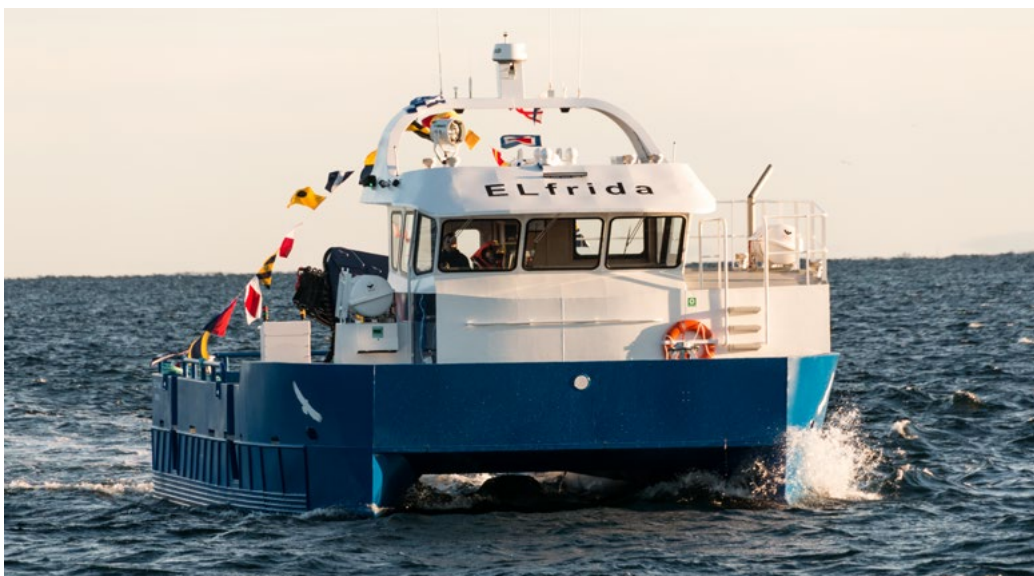
Den hybriidelektriske arbeidsbåten Elfrida, ble tatt i bruk av Salmar Farming i 2017, med 80-90 prosent elektrisk drift. Foto: Enova
