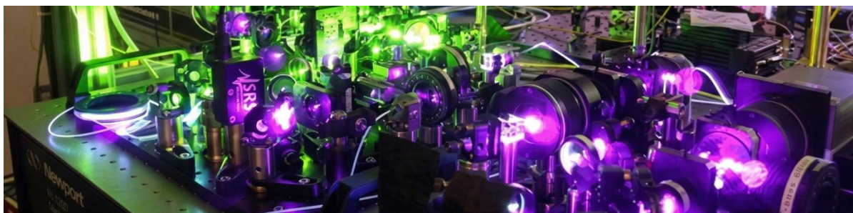
Figur 9: En optisk ytterbium-gitterklokke for tidfesting ved NMIJ (National Metrology Institute of Japan). NMIJ, National Metrology Institute of Japan. Oppskalert med KI. CC BY-SA 3.0, via Wikimedia Commons.
