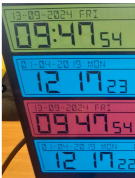
Figur 3: Eksempel på tilsiktet forstyrrelse fra Jammetest 2024 på Andøya. To av tre tidstjenere tillot at klokken ble stilt mer enn fem år tilbake i tid etter mottak av et tilsiktet feilaktig GNSS-signal (spoofing).
