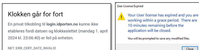
Figur 2: Eksempler på blokkert pålogging på grunn av tidsfeil mellom brukerens enhet og påloggingstjenesten. Feilmeldingen (venstre panel) indikerer at et sertifikat er ugyldig. Panelet til høyre indikerer at programvarelisensen har gått ut på dato.
