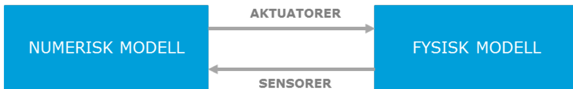
Figur 18 - Beskrivelse av sanntids-hybridtesting, kilde: MARINTEKs utviklingsplan for hybrid testing.
