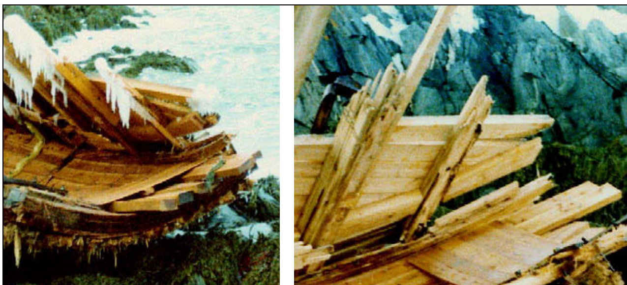
Figur: 7.15 Skader i skuteside og dekk akterut.
