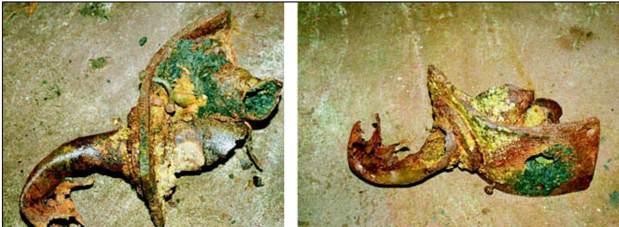
Figur: 7.8 Bøyd dekksgjennomføring.
