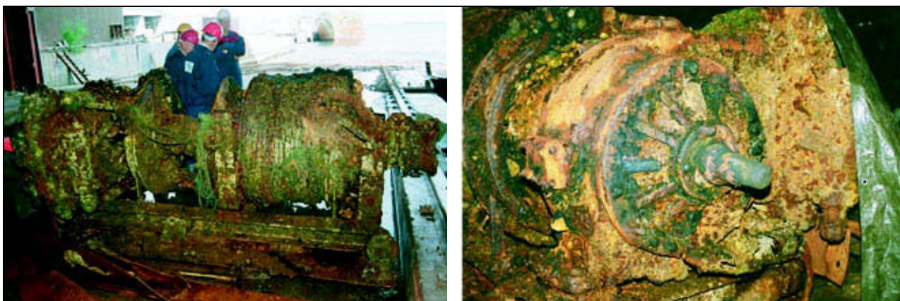
Figur: 7.9 Manglende kjettingkabelar og nokk på trålvinsjens styrbord side.
