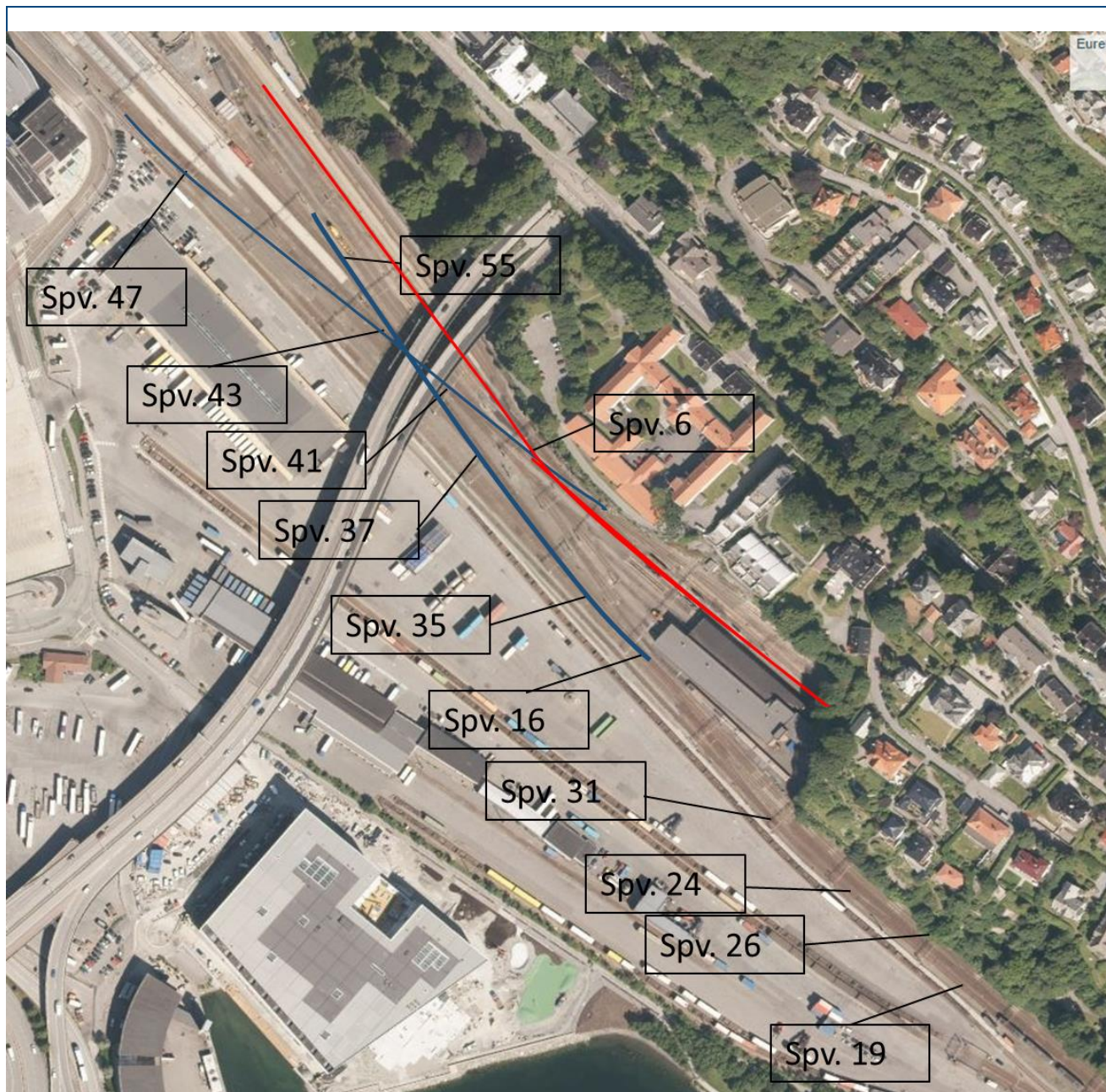
Figur 4 Sentrale sporveksler ved innkjøring til Bergen stasjon. Diagonalbevegelsene angitt i blått. Rødt angir innkjøringen til dagens hensettingsspor, fra uttrekkspor 27.
