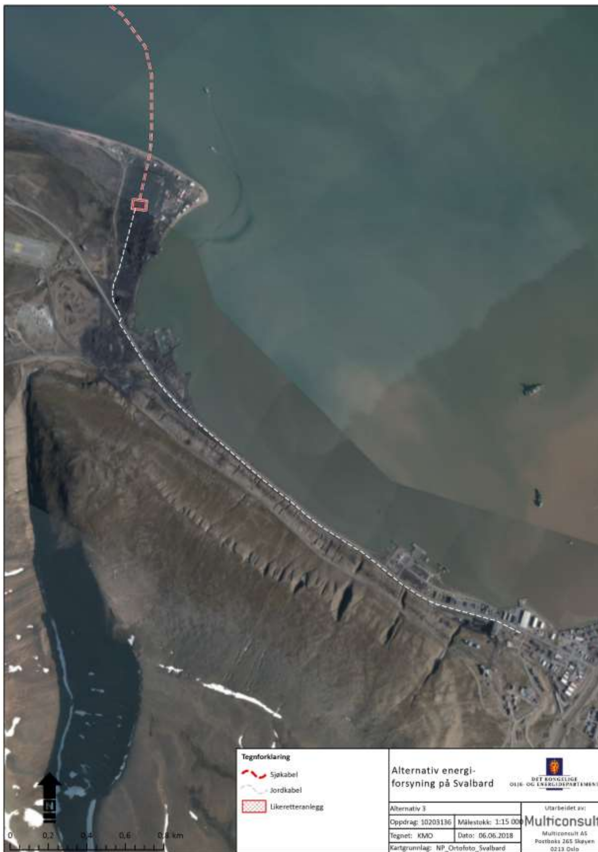
Figur 63: Prinsippskisse for alternativet med likeretteranlegg og sjøkabel fra Finnmark.
