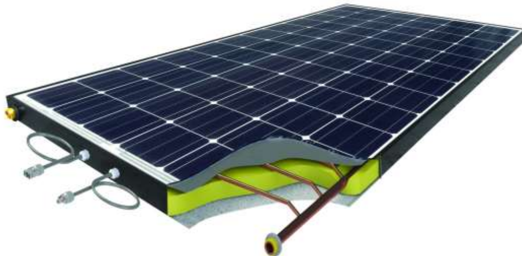
Figur 47: Prinsipp for en PV/T-modul. Solcellene er plassert på oversiden og på undersiden er varmerørene til solfangeren. Hver enkelt modul produserer både strøm og varme.
