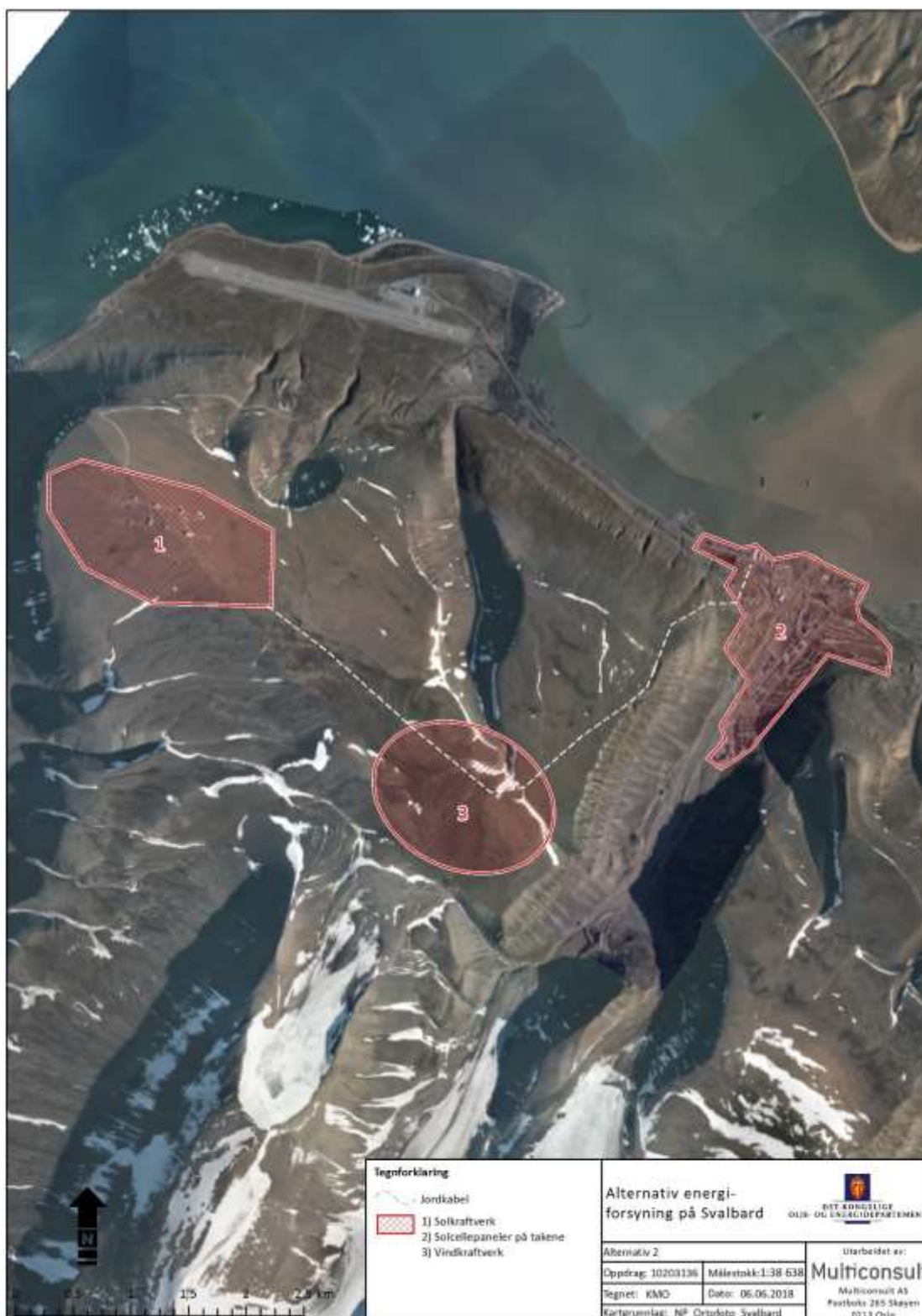
Figur 62: Prinsippskisse for alternativet med lokale fornybare energikilder.
