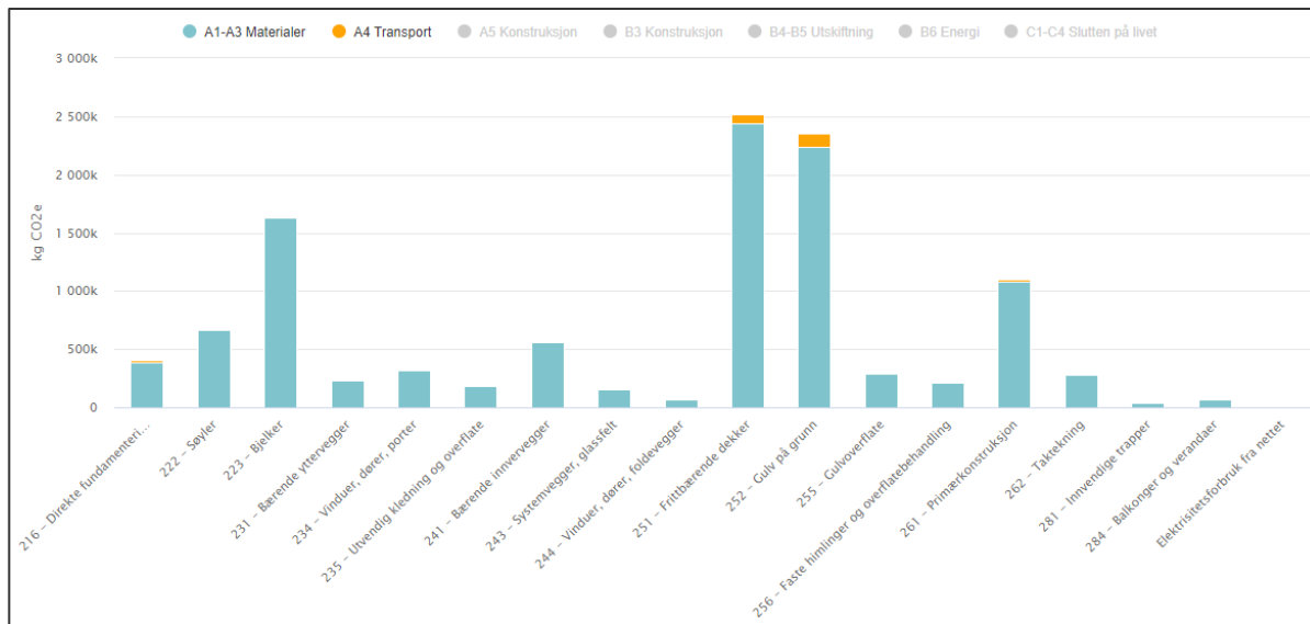
Figur 19. Klimagassutslipp per bygningsdel for erstatningsarealer på Gaustad sykehus. Mengder oppgitt i kg CO 2 -ekvivalenter. Planalternativ 1A.
