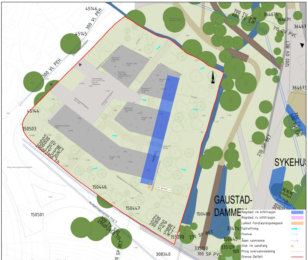
Figur 40: Konsept for overvannshåndtering for delfelt Slemdalsveien.
