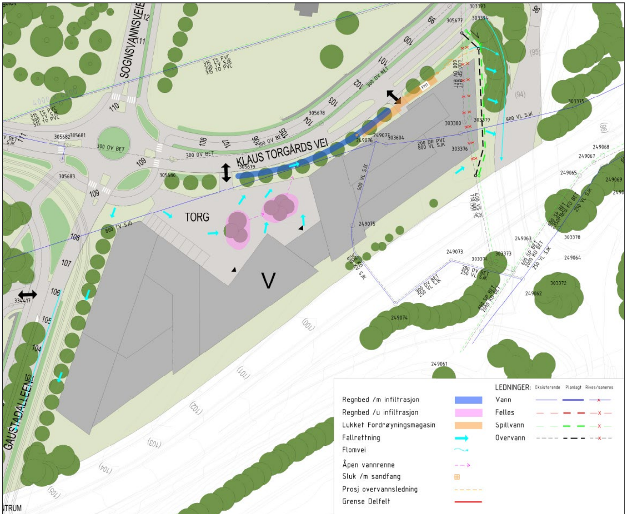
Figur 38: Konsept for overvannshåndtering for delfelt bygg V.
