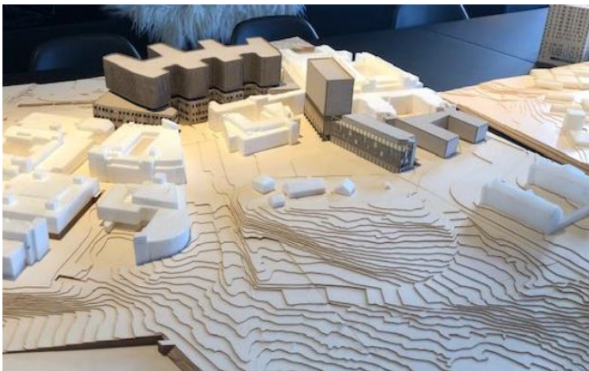
Figur 32: Bilde av fysisk modell. Illustrerer veiløsning med minst mulig inngrep i terreng ved å legge vei rundt østsiden av Lindekollen.
