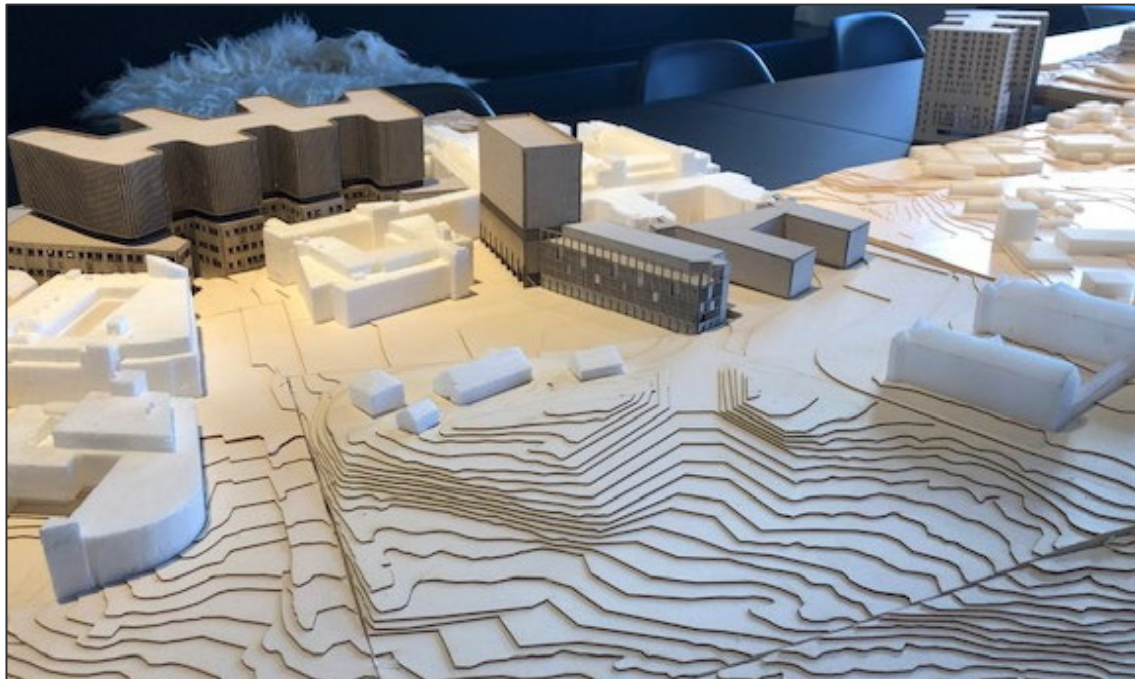
Figur 37: Bilde av fysisk modell som illustrerer inngrep i terrenget ved å lage skjæringer gjennom Lindekollen.
